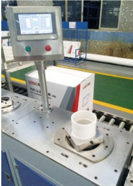
Pipe Socket Test 管件承口檢測
