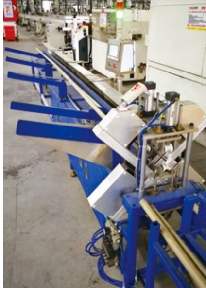
External Diameter Offline Test 外徑離線檢測
